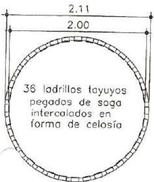
DETALLE PARED DE BROCAL DE POZO DE ABSORCIÓN
